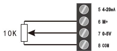
手动电位器调节,控制信号0-5Vdc
