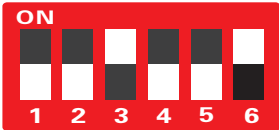
图5地址9时的拨码开关图中“白色”代表开关柄所在位置
