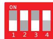
图4:站号5时的拨码开关
